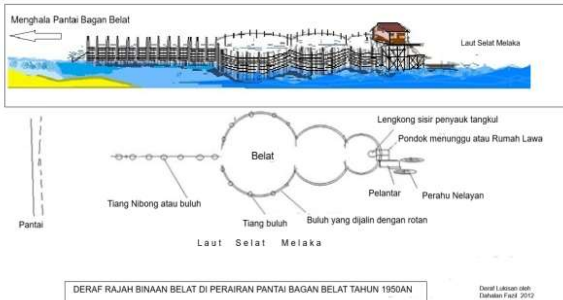
GAMBAR 24: Rajah pelan kasar dan struktur binaan belat dari info Pak Nad dan Pak Su Baharom bin Hassan, sekitar 1950an hingga 1960.
